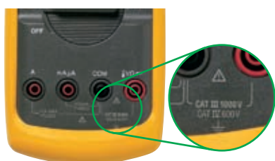
Utilizzate multimetri contrassegnati: 1000 V CAT III oppure 600 V CAT IV
